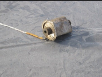
CONTENITORI CON URANIO IMPOVERITO Foto di: ARPA Valle d'Aosta Radionuclide: Uranio impoverito Provenienza: Rottami metallici (Acciaieria)
