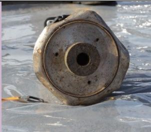
CONTENITORI CON URANIO IMPOVERITO Foto di: ARPA Valle d'Aosta Radionuclide: Uranio impoverito Provenienza: Rottami metallici (Acciaieria)
