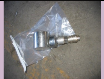
CONTENITORI CON URANIO IMPOVERITO Foto di: ARPA Valle d'Aosta Radionuclide: Uranio impoverito Provenienza: Rottami metallici (Acciaieria)
