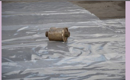
CONTENITORI CON URANIO IMPOVERITO Foto di: ARPA Valle d'Aosta Radionuclide: U-238 depleted Provenienza: Rottami metallici (Acciaieria)
