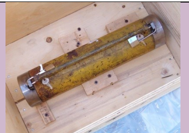
CONTENITORE DI PIOMBO PER SORGENTI Foto di: ARPA Friuli Venezia Giulia Radionuclide: Co-60 Provenienza: Azienda metallurgica (magazzino)
