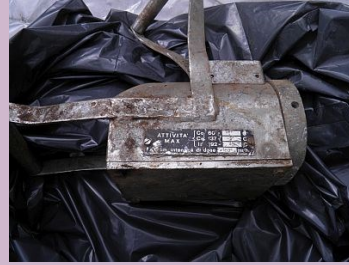
CONTENITORE CON URANIO IMPOVERITO Foto di: ARPA Friuli Venezia Giulia Radionuclide: Uranio impoverito Provenienza: Rottami metallici (Acciaieria)
