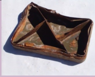
COPERCHIO DELLA SCATOLA Foto di: ARPA Friuli Venezia Giulia Radionuclide: Ra-226 Provenienza: Rottami metallici (Confine di Stato)
