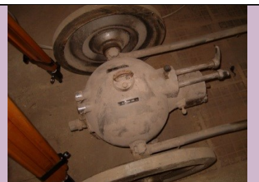
CONTENITORE CARRELLATO CON 2 SORGENTI Foto di: ARPA Friuli Venezia Giulia Radionuclide: Co-60; Cs-137 Provenienza: Azienda privata
