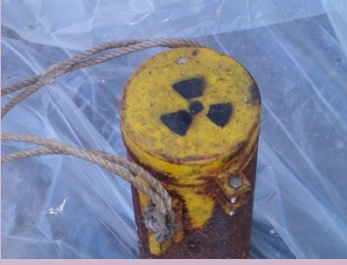
CONTENITORE DI PIOMBO PER SORGENTI Foto di: ARPA Friuli Venezia Giulia Radionuclide: Co-60 Provenienza: Azienda metallurgica (magazzino)
