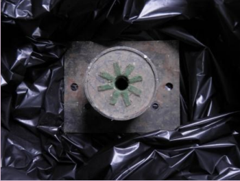
CONTENITORE DI PIOMBO PER SORGENTI Foto di: ARPA Friuli Venezia Giulia Radionuclide: Co-60 Provenienza: Impianto termovalorizzatore
