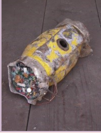
CONTENITORE SCHERMATO Foto di: ARPA Friuli Venezia Giulia Radionuclide: Ra-226 Provenienza: Rottami metallici (Acciaieria)
