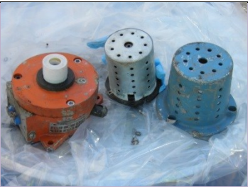
RIVELATORE DI FUMO TESLA (DISPOSITIVO SMONTATO) Foto di: ARPA Friuli Venezia Giulia Radionuclide: Am-241 Provenienza: Rottami metallici (Acciaieria)
