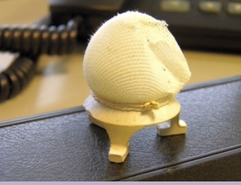
RETICELLA RIGIDA PER LAMPADA DA CAMPEGGIO Foto di: ARPA Friuli Venezia Giulia Radionuclide: Th-232 Provenienza:
