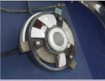
PARAFULMINE HELITA Foto di: ARPA Liguria Radionuclide: Ra-226 Provenienza: Impianto trattamento rifiuti
