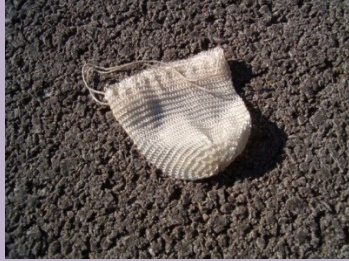
RETICELLA PER LAMPADA DA CAMPEGGIO Foto di: ARPA Friuli Venezia Giulia Radionuclide: Th-232 Provenienza:
