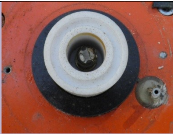
RIVELATORE DI FUMO TESLA (PARTICOLARE) Foto di: ARPA Friuli Venezia Giulia Radionuclide: Am-241 Provenienza: Rottami metallici (Acciaieria)
