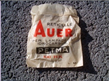
RETICELLA CONFEZIONATA PER LAMPADA DA CAMPEGGIO Foto di: ARPA Friuli Venezia Giulia Radionuclide: Th-232 Provenienza:
