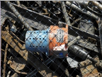
RIVELATORE DI FUMO TESLA Foto di: ARPA Friuli Venezia Giulia Radionuclide: Am-241 Provenienza: Rottami metallici (Acciaieria)
