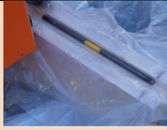
BARRETTA DI CO-60 Foto di: ARPA Friuli Venezia Giulia Radionuclide: Co-60 Provenienza: Azienda metallurgica
