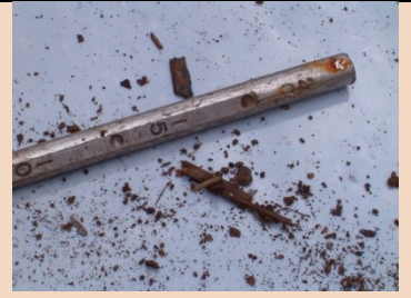
BARRETTA GRADUATA DI CS-137 Foto di: ARPA Friuli Venezia Giulia Radionuclide: Cs-137 Provenienza: Rottami metallici (Confine di Stato)
