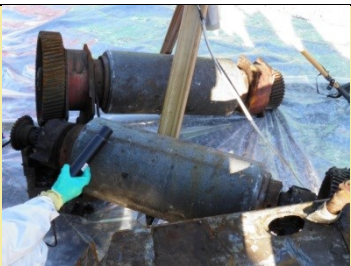
RULLI CON RIVESTIMENTO GRANITICO Foto di: ARPA Friuli Venezia Giulia Radionuclide: U-238; Th-232 Provenienza: Rottami metallici (Acciaieria)
