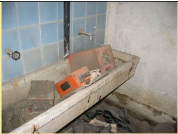
SISTEMA PER IL MONITORAGGIO IN CONTINUO DELLO SPESSORE Foto di: ARPA Valle d'Aosta Radionuclide: Kr-85; Sr-90 Provenienza: Stabilimento ind.le dismesso
