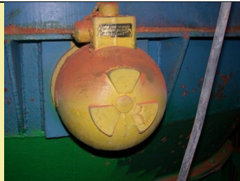
MISURATORE DI LIVELLO IN SILOS Foto di: ARPA Liguria Radionuclide: Co-60 Provenienza: Stabilimento ind.le dismesso
