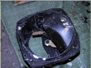
VIRO-SBANDOMETRO (QUADRANTE) Foto di: ARPA Friuli Venezia Giulia Radionuclide: Ra-226 Provenienza: Impianto termovalorizzatore
