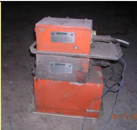
SISTEMA PER IL MONITORAGGIO IN CONTINUO DELLO SPESSORE Foto di: ARPA Valle d'Aosta Radionuclide: Kr-85; Sr-90 Provenienza: Stabilimento ind.le dismesso
