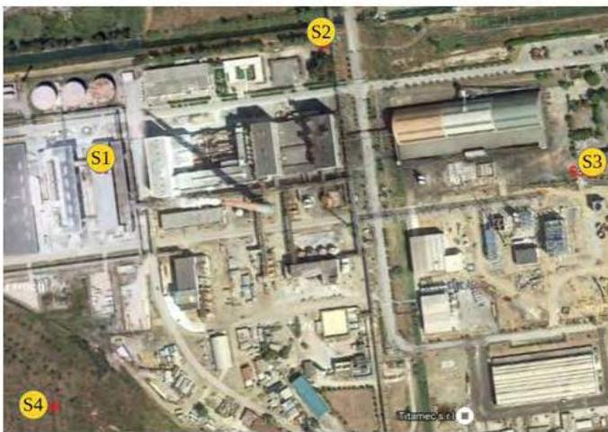
Nel sedime di impianto sono stati installati, da inizio 2015, una serie di sensori di H2S (S1,2,3,4 nella figura) in modo tale da poter monitorare le ricadute di H2S dei fumi emessi dai camini dei reattori dove viene effettuato l'attacco della scoria titanifera. La rete dei sensori si è dimostrata sino ad oggi efficace ed affidabile. Inoltre nella zona sono presenti anche due centraline di monitoraggio della qualità dell'aria nel comune di Follonica ed a Scarlino Scalo.
